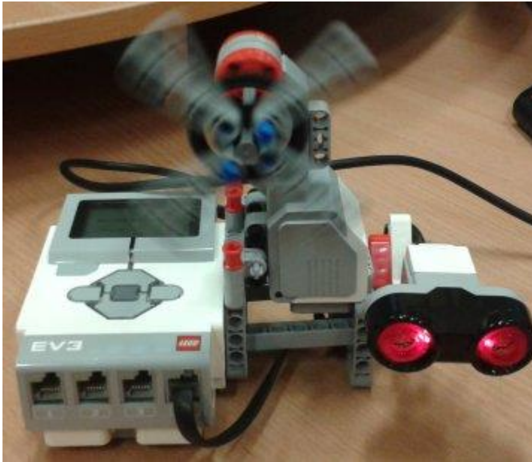
LEGO® MINDSTORMS® Education EV3 Model wentylatora (układ: sensor – kostka sterująca – silnik)
